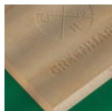
Postiže se pomoću laserskog zraka visoke preciznosti, omogućavajući detaljno graviranje u bareljevu. Izaberite laser sa optičkim vlaknima za metal ili CO<sub>2</sub> laser za drvo ili plutu.
